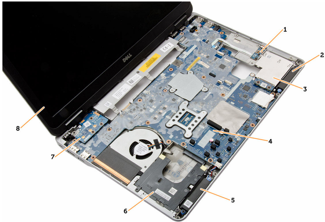
Afbeelding 2. Bovenaanzicht: toetsenbord en polssteun verwijderd
